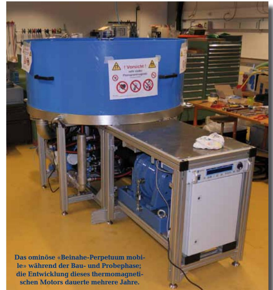
Das ominöse «Beinahe-Perpetuum mobile» während der Bau- und Probephase; die Entwicklung dieses thermomagnetischen Motors dauerte mehrere Jahre.
